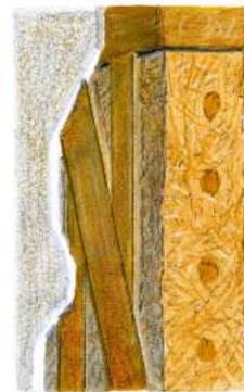
*mur en pan de bois et torcbeis enduit à la chaux*
