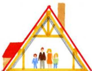
Dans le cas désormais fréquent du comble devenu habitable, l'isolant est placé en « rampant », en sous-face de la couverture. La contrainte principale étant de maintenir l'aération des bois de charpente et des supports de la couverture (lattis, voligeage).
