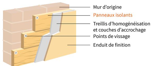
Les panneaux isolants sont fixés au mur par collage et/ou vissage. Ils sont recouverts d'un treillis collé puis d'un enduit de finition. C'est la solution la moins chère en isolation par l'extérieur.
