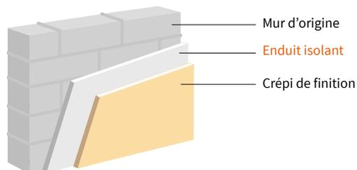
Le système se compose d'un enduit isolant minéral ou végétal projeté ou coffré sur le mur à l'extérieur de l'habitation, et couvert d'un crépi de finition. Tous ces matériaux doivent permettre
