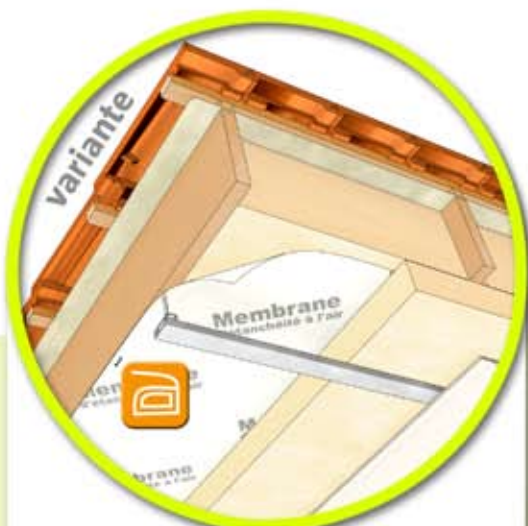
Membrane entre les deux couches d'isolants
