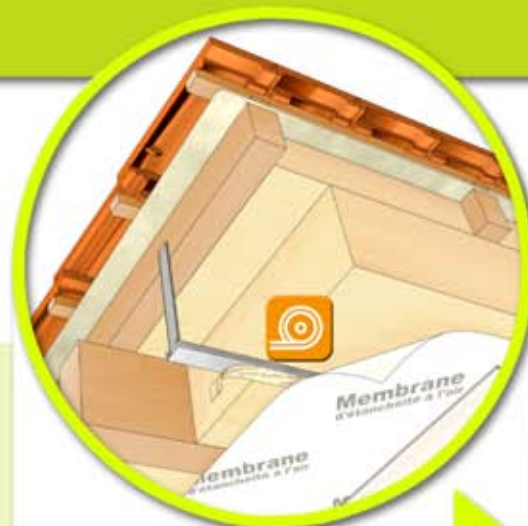
Membrane scotchée sur rail
