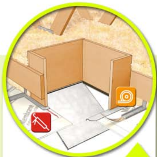
Raccordement à une trappe
