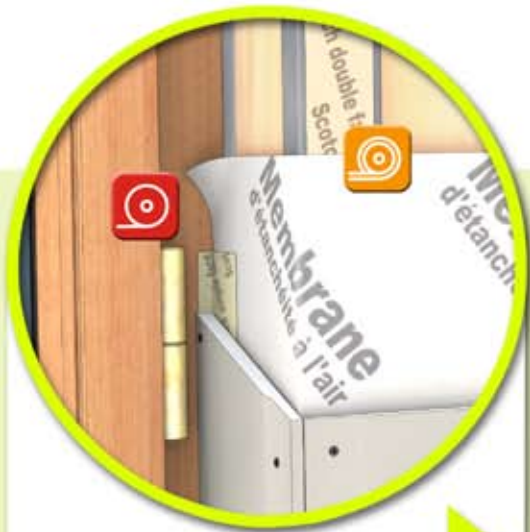
Raccordement à une lucarne
