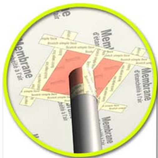
Traversée par des tuyaux de gros diamètre
