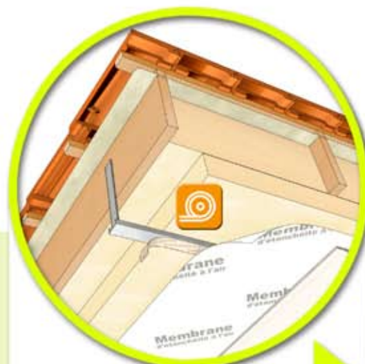
Membrane scotchée sur rail
