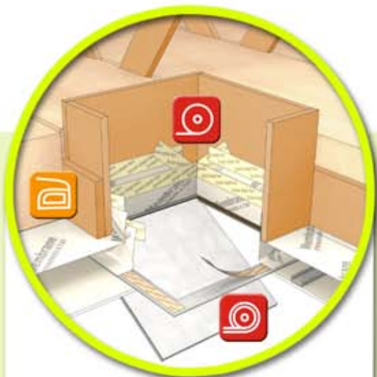
Trappe avec plénum technique
