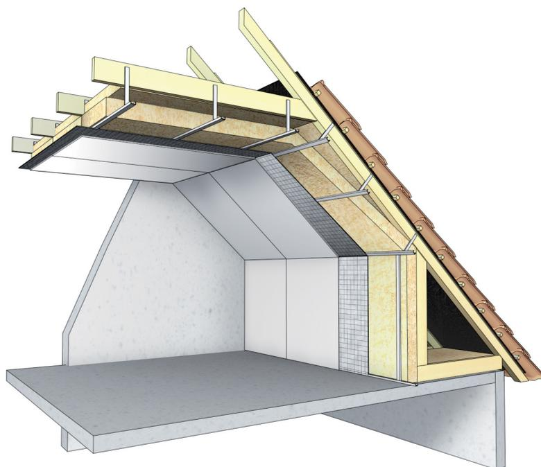
▲ Figure 14 : Isolation thermique de rampant et pied-droit en combles aménagés, fermettes industrielles en A, parement sur ossature métallique (représentation avec plancher béton)
