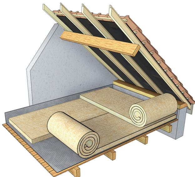
▲ Figure 5 : Isolation en combles perdus sur plancher bois
