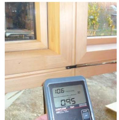
Mise en évidence d'un défaut d'étanchéité entre dormant et ouvrant de la menuiserie
