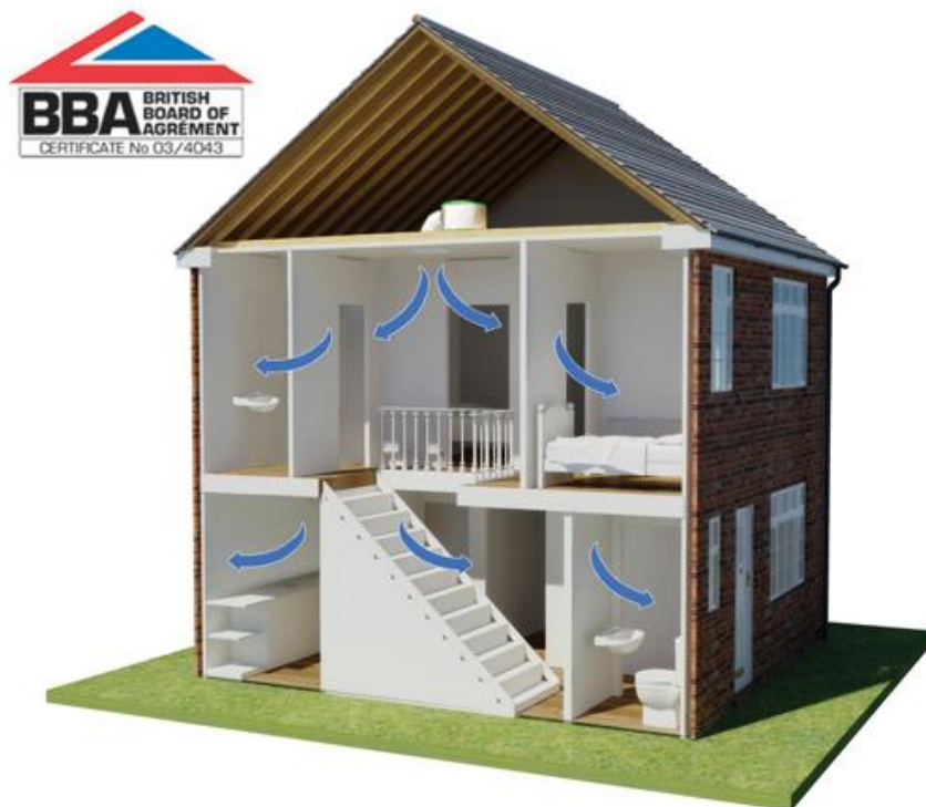
Figure 30 : PMIV ventilation centralisée par insufflation (ENVIROVENT)
