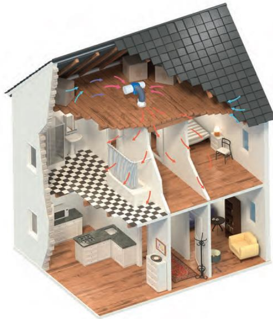
Figure 34 : PIV ventilation centralisée par insufflation (NUAIRE)
