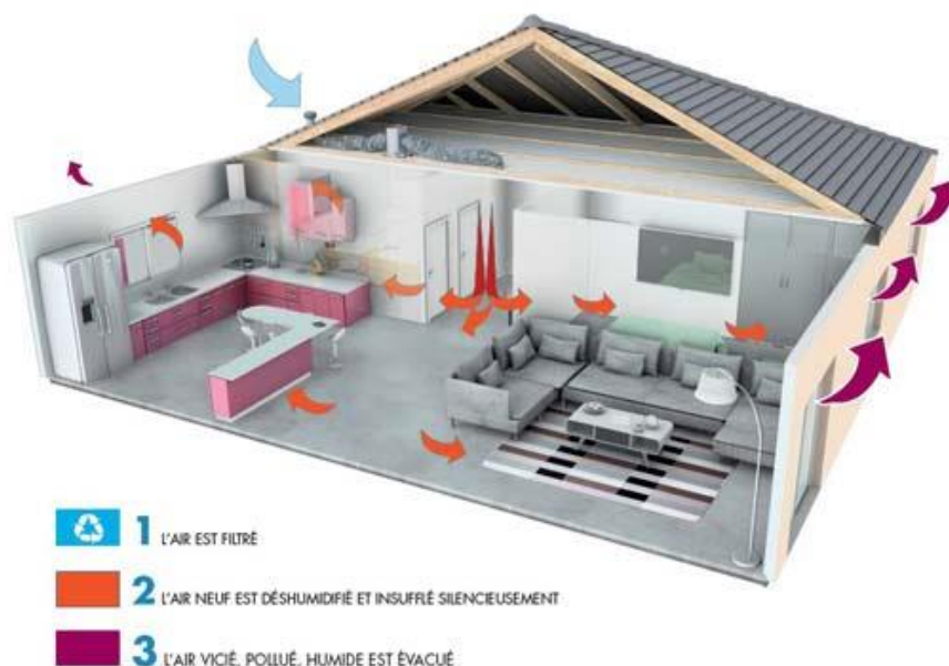
Figure 31 : VPH, ventilation centralisée par insufflation (EOLETEC)
