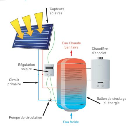
Le chauffe-eau solaire est constitué de 5 éléments principaux :
