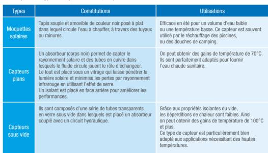
Remarque : les capteurs fréquemment utilisés pour les CESI (chauffe eau solaire individuel) sont les capteurs plans. Les capteurs sous vide sont préférés pour des climats rigoureux.
