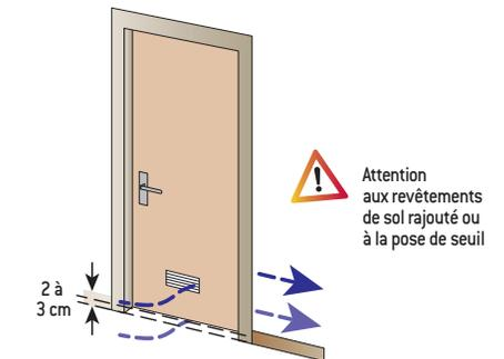
La diffusion entre les pièces et la bouche de reprise sera assurée par un détalonnage des portes intérieures ou une grille de transfert.
