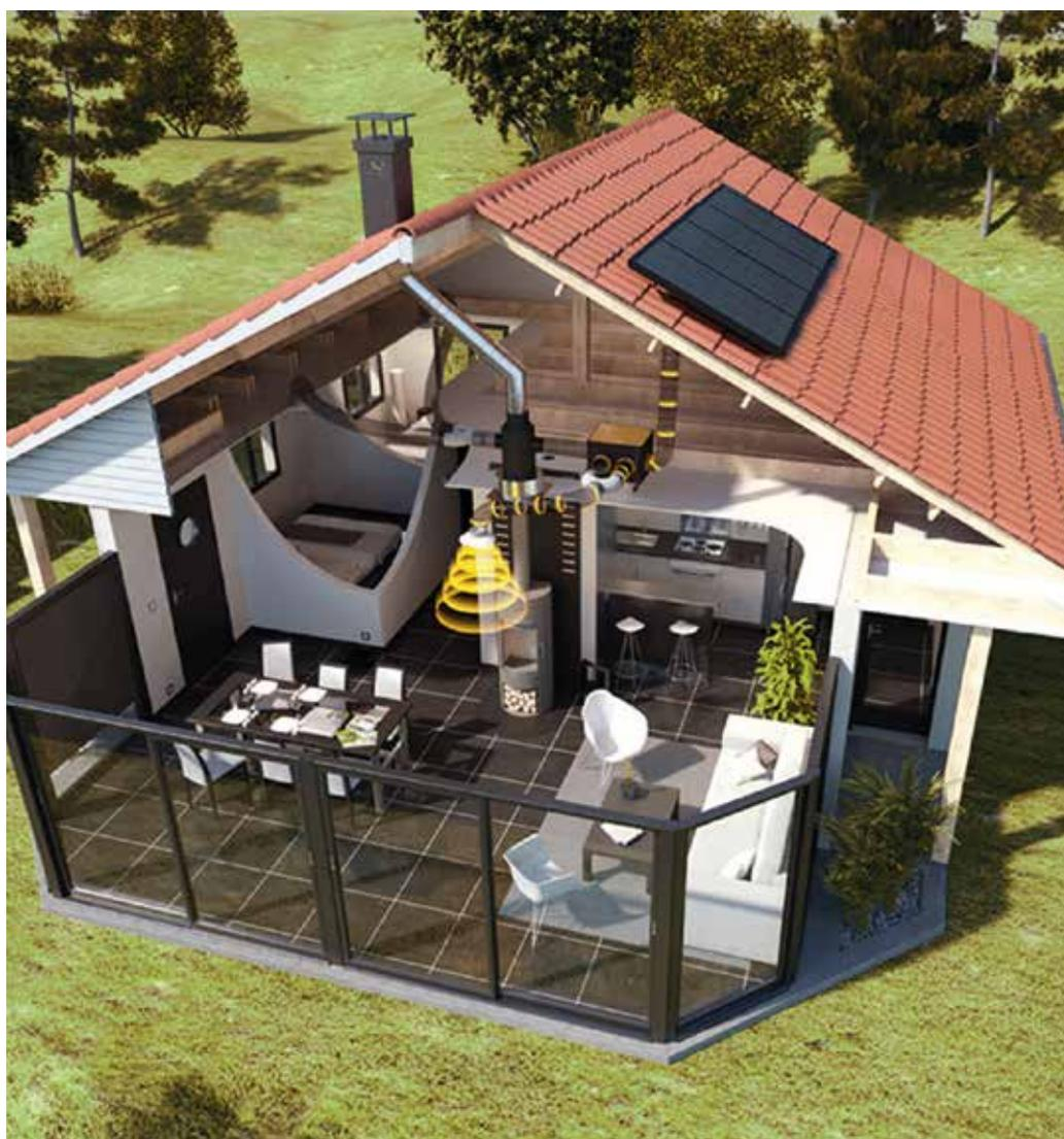
SUNWOOD chauffe ou rafraîchit la maison suivant la température demandée, favorisant le confort de l'habitant. Le Module motorisé pilote la chaleur de source solaire ou générée par la combustion de l'appareil bois. SUNWOOD-PV produit en plus de l'électricité photovoltaïque pour favoriser l'autonomie énergétique et répondre aux besoins de la maison.
