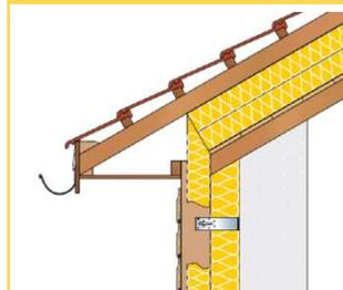
La performance du logement est plus importante si l'isolation et l'étanchéité à l'air est continue.
