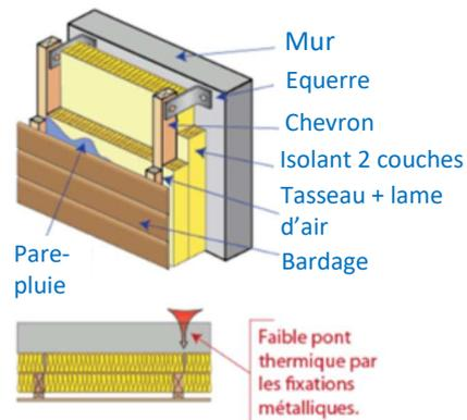
Schéma ossature avec isolation continue
