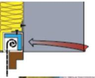
Disparition du pont thermique car le volet est isolé et intégré dans l'épaisseur de l'isolation extérieure.
