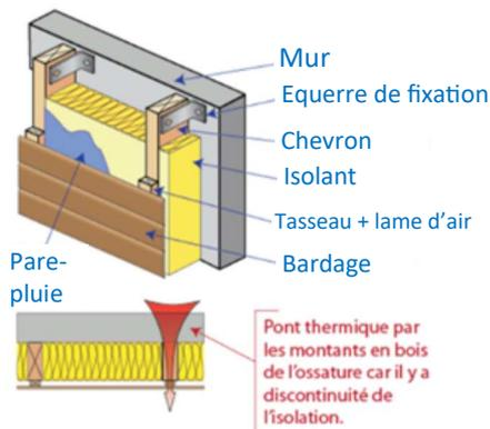
Schéma ossature avec isolation non continue
