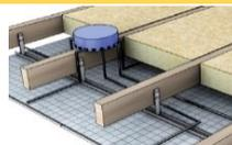
Les câbles doivent être visibles grâce à des repères etc...
