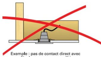
Exemple : pas de contact direct avec l'isolant en vrac ou soufflé
