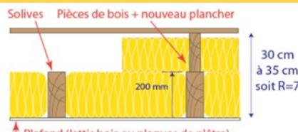
Rehausser avec des poutres + isoler avec 30-35 cm + fixer un nouveau plancher
