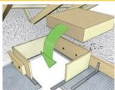
La trappe d'accès doit être isolée et étanche à l'air
