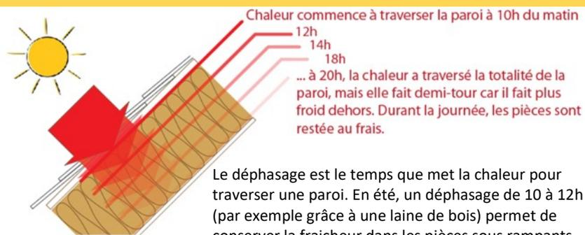
Le déphasage est le temps que met la chaleur pour traverser une paroi. En été, un déphasage de 10 à 12h (par exemple grâce à une laine de bois) permet de conserver la fraîcheur dans les pièces sous rampants.
