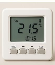
Pour tirer pleinement parti des performances d'une pompe à chaleur, il est indispensable de l'équiper d'un thermostat d'ambiance adapté et d'un système de régulation intelligent. Ces éléments assurent une gestion fine du chauffage en fonction des besoins réels du bâtiment et des utilisateurs, tout en maximisant les économies d'énergie. La régulation devra être de catégorie IV pour bénéficier d'aide financières.
